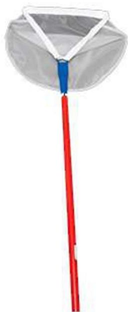
Рисунок. Сачок гидробиологический
