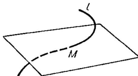
**Рисунок 7.** Соприкасающаяся плоскость
