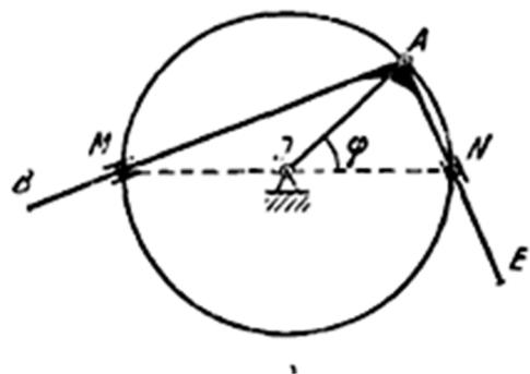
прямого угла  $AB$  проходит непрерывно через неподвижную точку  $M$ , а стержень  $AE$  – через неподвижную точку  $N$ . Тогда  $M$  и  $N$  лежат на окружности, описываемой вершиной прямого угла  $A$ . Определить угловую скорость жесткого прямого угла  $BAE$ , а также скорости тех его точек, которые совпадают в данный момент с шарнирами  $M$  и  $N$ .
