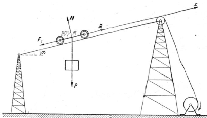
вагонетки в ход и при ее последующем равномерном движении, если пуск в ход осуществляется равноускоренно из состояния покоя в течении  $T$  секунд. К концу пускового периода вагонетка приобрела скорость  $v$ . На вагонетку действует сила сопротивления  $F_c = fN$ , где  $N$  – модуль нормального давления вагонетки на канат, а  $f$  – постоянный коэффициент. Прогибом каната пренебречь.
