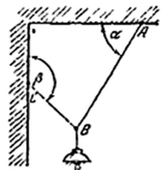
веревкой  $BC$ . Определить натяжения  $T_A$  шнура  $AB$  и  $T_C$  веревки  $BC$ , если известно, что угол  $\alpha = 60^\circ$ , а угол  $\beta = 135^\circ$ . Весом шнура и веревки пренебречь.
