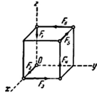
9. По ребрам прямоугольного параллелепипеда, соответственно равным 10, 4 и 5 м, действуют шесть сил, указанных на чертеже:  $P_1 = 4$  Н,  $P_2 = 6$  Н,  $P_3 = 3$  Н,  $P_4 = 2$  Н,  $P_5 = 6$  Н,  $P_6 = 8$  Н. Привести эту систему сил к каноническому виду и определить координаты  $x$  и  $y$  точки пересечения центральной винтовой оси с плоскостью  $Oxy$ .
