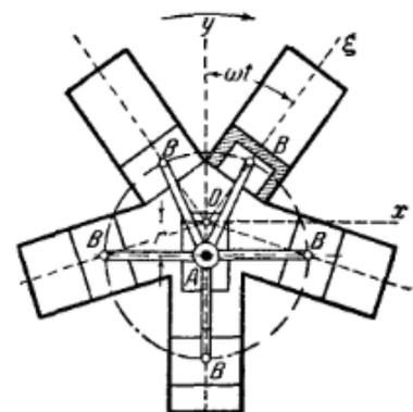
3. Определить абсолютную скорость поршня ротативного двигателя при двух вертикальных и двух горизонтальных положениях шатуна  $AB$ , если длина кривошипа  $OA = r = 80$  мм, длина шатуна  $AB = l = 240$  мм, число оборотов цилиндра с картером  $n = 1200$  об/мин.
