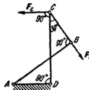
приложенной в шарнире  $B$  перпендикулярно к звену  $AB$ , если механизм находится в равновесии в положении, указанном на чертеже. Дано:  $AD = BC$ ,  $AB = CD$ ,  $ABC = ADC = 90^\circ$ ,  $DCB = 30^\circ$ .
