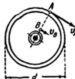
3. Маховое колесо радиуса  $R = 2 \text{ м}$  вращается равноускоренно из состояния покоя; через  $t = 10 \text{ с}$  точки, лежащие на ободке, обладают линейной скоростью  $v = 100 \text{ м/с}$ . Найти скорость, нормальное и касательное ускорения точек обода колеса для момента  $t = 15 \text{ с}$ .
