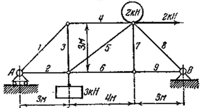
8. Определить опорные реакции и усилия в стержнях навесной фермы, изображенной вместе с действующими на нее силами на рисунке.
