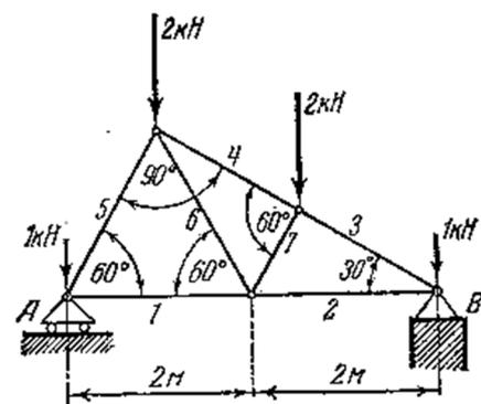
4. Определить опорные реакции и усилия в стержнях фермы крана, изображенного вместе с приложенными к нему силами на рисунке.
