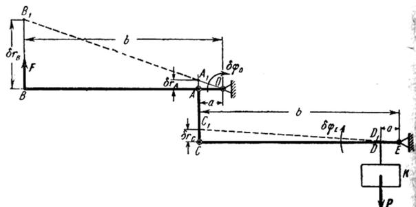
приложенной в точке  $B$  верхнего рычага. Определить вес  $P$  поднимаемого груза  $K$ , если  $F = 10 \text{ кг}$ , а  $\frac{b}{a} = 10$ .
