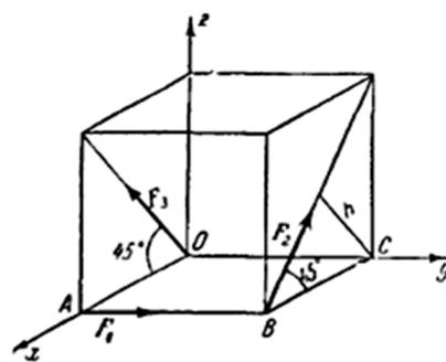
2. Привести к простейшему виду систему сил  $F_1, F_2, F_3, F_4$  и  $F_5$ , приложенных в вершинах  $A, K$  и  $C$  прямоугольного параллелепипеда  $OABCDEKL$ ;  $F_1 = F_3 = F_4 = F_5 = F$ ,  $F_2 = 2F$ ,  $OC = a$ ,  $OA = a/2$ .
