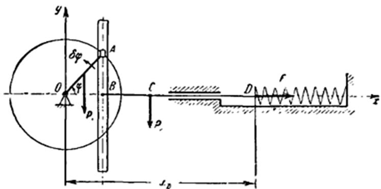
изображенного на рисунке. К концу  $D$  штока  $BO$  кулисы прикреплена пружина, коэффициент жесткости которой равен  $c$ . При крайнем правом положении кулисы пружина не деформирована. Вес кривошипа  $OA$  равен  $P_1$ ,  $r$  - длина кривошипа. Массами камня  $A$  кулисы и пружины пренебречь. Кривошип  $OA$  считать однородным стержнем. Механизм расположен в вертикальной плоскости. Силами сопротивления пренебречь.
