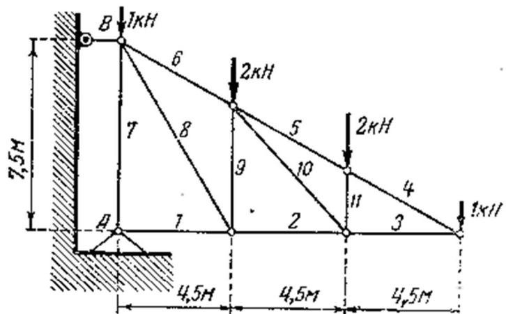
9. Определить опорные реакции и усилия в стержнях сооружения, изображенного вместе с приложенными к нему силами на рисунке. Стержни 3 и
