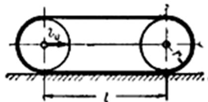
2. Вычислить кинетическую энергию гусеницы трактора, движущегося со скоростью  $v_0$ . Расстояние между осями колес равно  $l$ , радиусы колес равны  $r$ , вес одного погонного метра гусеничной цепи равен  $\gamma$ .
