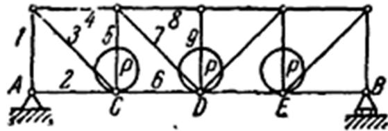
2. Для сборки моста устроен временный деревянный кран, перемещающийся по рельсам  $A$  и  $B$  на колесах. К среднему узлу  $C$  нижнего пояса  $DE$  крана прикреплен блок, служащий для поднятия тяжестей с помощью цепи. Вес поднимаемого с подмостей груза  $P = 5$  т, причем в момент отделения его от подмостей направление цепи составляет с вертикалью угол  $\alpha = 20^\circ$ ; во избежание колебаний груза он оттягивается горизонтальным канатом  $GH$ .
