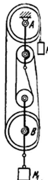
5. Составить уравнение движения маятника, состоящего из материальной точки  $M$  массы  $m$ , подвешенной на нити, накрутой на неподвижный цилиндр радиуса  $r$ . Длина свисающей в положении равновесия части нити равна  $l$ . Массой нити пренебречь.
