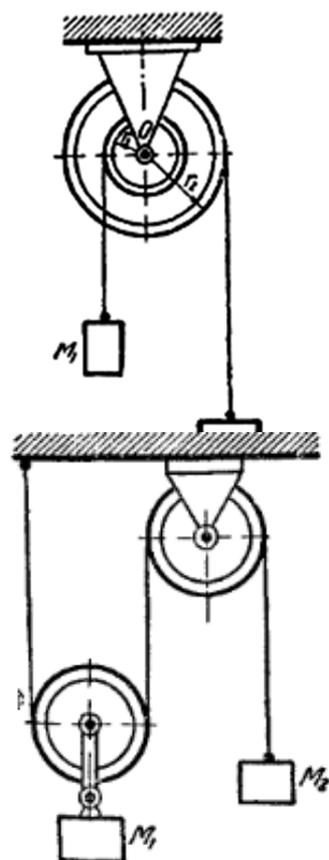
Определить угловое ускорение барабанов, пренебрегая их массами и массой нитей.
