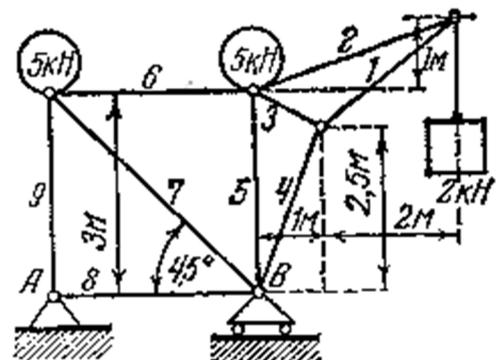
5. Определить опорные реакции и усилия в стержнях сооружения, изображенного вместе с действующими на него силами на рисунке.
