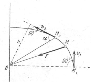
6. Шарик массы  $m$ , привязанный к нерастяжимой нити, скользит по гладкой горизонтальной плоскости; другой конец нити втягивают с постоянной скоростью  $a$  в отверстие, сделанное на плоскости.
