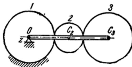
планетарной передачи относительно неподвижной оси  $z$ , совпадающей с осью вращения кривошипа  $OC_3$ . Неподвижное колесо 1 и подвижное колесо 3 - одинакового радиуса  $r$ . Масса колеса 3 равна  $m$ . Колесо 2 массой  $m_2$  имеет радиус  $r_2$ . Кривошип вращается с угловой скоростью, проекция которой на ось  $z$  равна  $\omega_z$ . Массой кривошипа пренебречь. Колеса считать однородными дисками.
