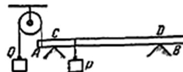
12. Горизонтальная балка крана, длина которой равна  $l$ , у одного конца укреплена шарнирно, а у другого конца  $B$  подвешена к стене посредством тяги  $BC$ , угол наклона которой к горизонту равен  $\alpha$ . По балке может перемещаться груз
