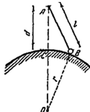
10. Блок  $C$  с грузом  $P = 80$  кН может скользить вдоль гибкого троса  $ACB$ , концы которого  $A$  и  $B$  прикреплены к стенам. Расстояние между стенами 4 м, длина троса 5 м. Определить натяжение троса при равновесии блока с грузом, пренебрегая весом троса и трением блока о трос.
