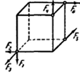
5. По трем непересекающимся и непараллельным ребрам прямоугольного параллелепипеда действуют три равные силы  $P$ . Какое соотношение должно существовать между ребрами  $a, b$  и  $c$ , чтобы эта система приводилась к одной равнодействующей?
