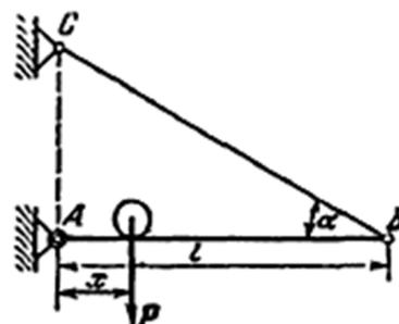
$P$ , положение которого определяется переменным расстоянием  $x$  до шарнира  $A$ . Определить натяжение  $T$  тяги  $BC$  в зависимости от положения груза. Весом балки пренебречь.
