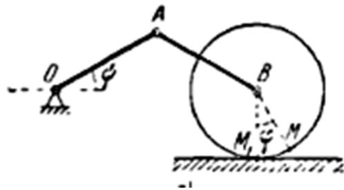
2. Вершина  $A$  жесткого прямого угла  $BAE$  соединена кривошипом  $OA = r$  с неподвижным центром  $O$ . Кривошип  $OA$  вращается равномерно:  $\varphi = kt$ . Сторона
