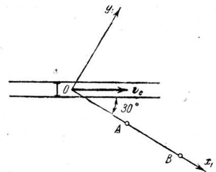
постоянной скоростью, равной по величине  $1$  м/с. Определить абсолютную скорость и абсолютное ускорение груза в моменты
