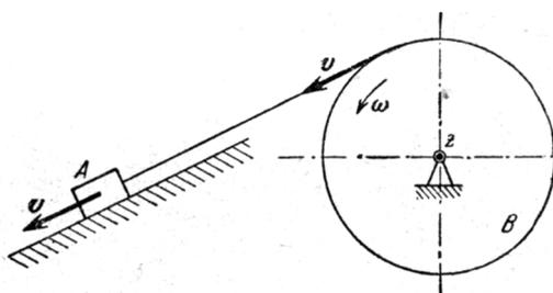
8. Груз веса  $P = 20 \text{ кг}$  поднимается по наклонной плоскости посредством веревки, расположенной под углом  $\alpha = 30^\circ$  к плоскости.
