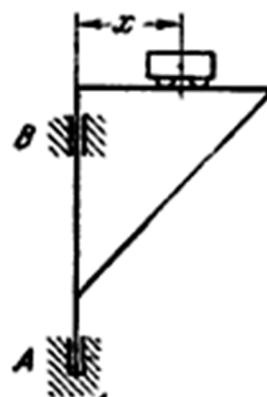
6. Твердое тело вращается вокруг неподвижной оси под действием приложенной к нему системы сил. Чему должен быть равен главный момент внешних сил относительно оси
