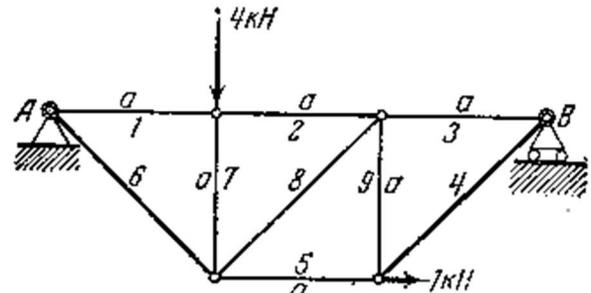
7. Определить опорные реакции и усилия в стержнях мостовой фермы, которая вместе с приложенными к ней силами изображена на рисунке.
