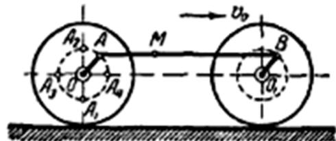
6. На тележке, движущейся по горизонтали вправо с ускорением  $\omega = 49,2$  см/с<sup>2</sup>, установлен электрический мотор, ротор которого при пуске в ход вращается согласно уравнению  $\varphi = t^2$ , причем угол  $\varphi$  измеряется в радианах. Радиус ротора равен 20 см. Определить абсолютное ускорение точки  $A$ , лежащей
