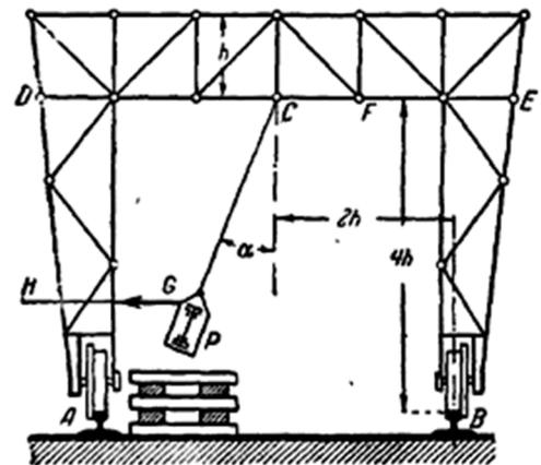
Предполагая, что горизонтальная составляющая натяжения цепи воспринимается одним правым рельсом  $B$ , определить усилие  $S_1$  в горизонтальном стержне  $CF$  в момент отделения груза от подмостей и сравнить его с тем усилием  $S_2$ , которое получилось бы при угле  $\alpha = 0^\circ$ . Размеры указаны на чертеже.
