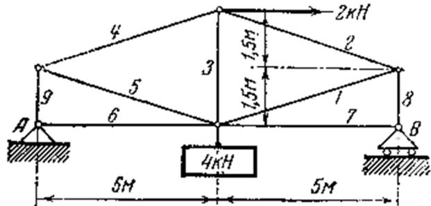
6. Определить опорные реакции и усилия в стержнях раскосой фермы, изображенной на рисунке вместе с нагрузкой.
